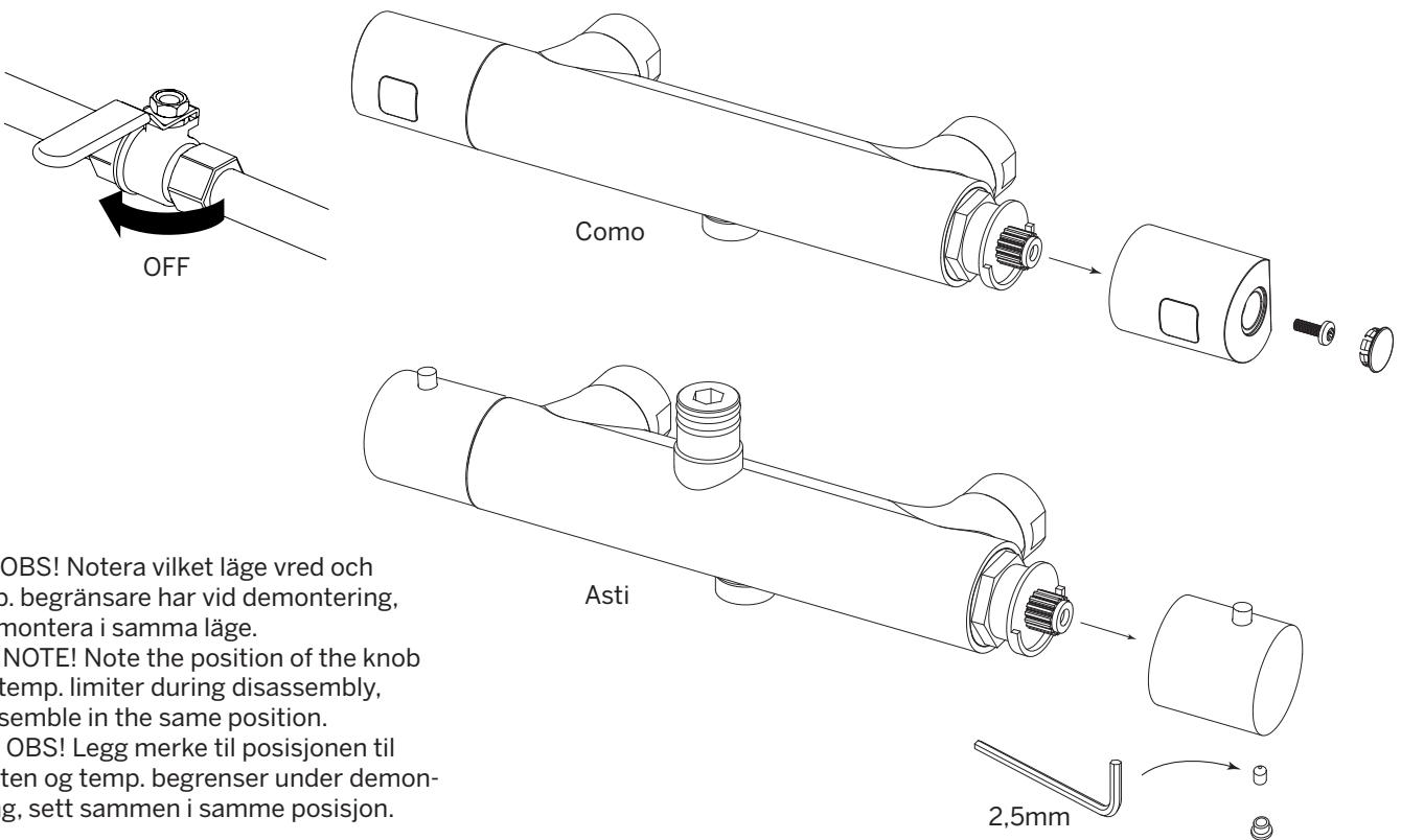
SV - OBS! Notera vilket läge vred och temp. begränsare har vid demontering, återmontera i samma läge.
