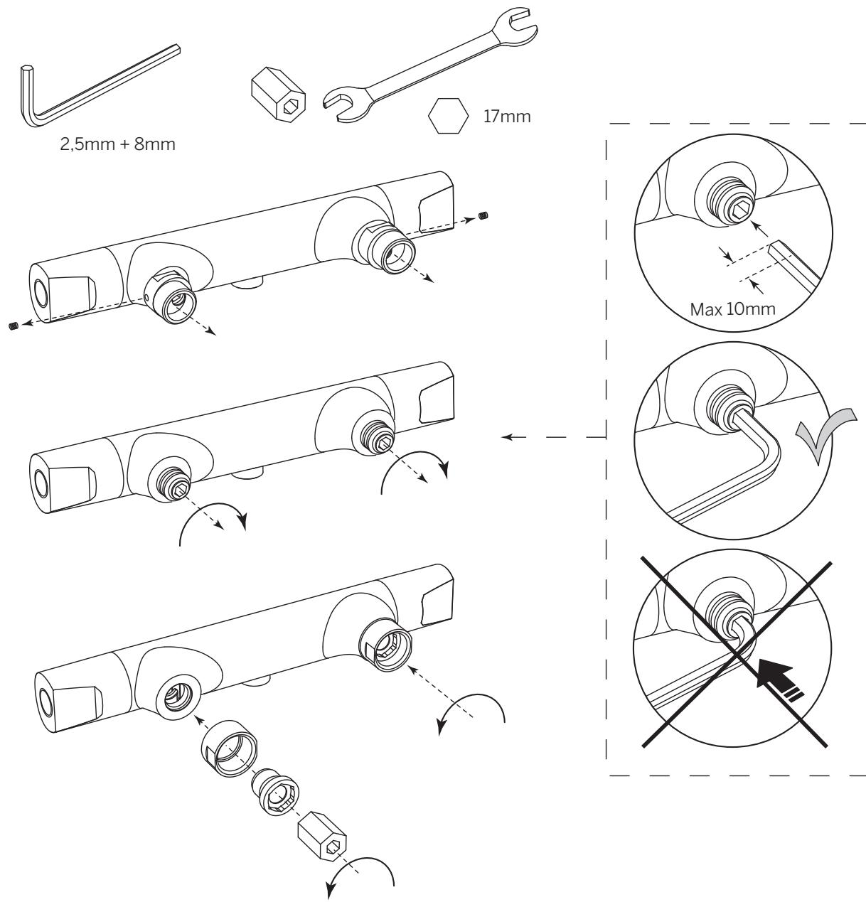
**SV** - Vid c/c 160 ska medföljande silfilter monteras.
