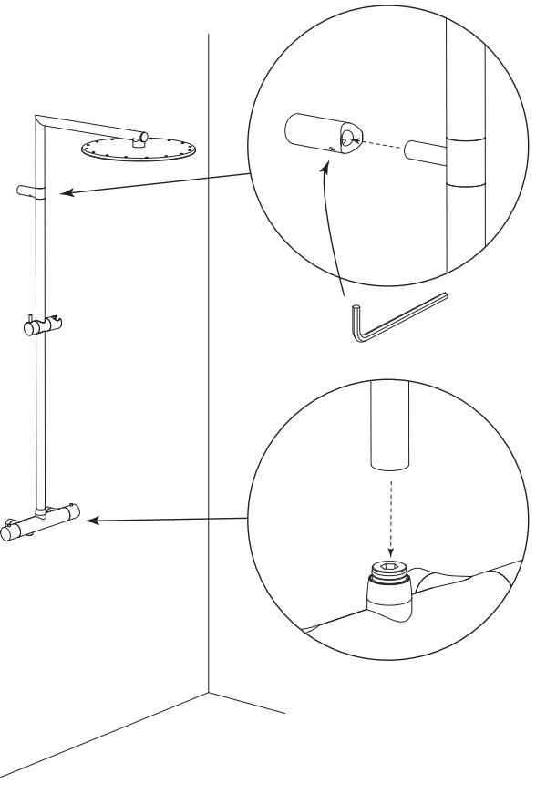
**SV - OBS:** Alla infästning i våtzon 1 och 2 ska tätas mot väggens eller golvens tätskikt. Material för tätning ska fästa mot underlaget och vara vattenbeständigt, mögelresistent och åldringsbeständigt. Beroende av väggmaterial, skall metoden för väggmontering anpassas (Ev. förborring, plugg etc.). Tala med Er återförsäljare. Denna produkt är anpassad till Branschregler Säker Vatteninstalltion.
